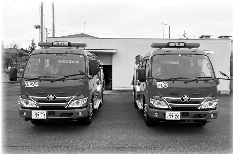
今回更新した普通消防ポンプ自動車は、最新型のCD-1型消防ポンプ自動車です。第24分団車両(左)には山間部の狭い場所でも自然水利を使って消火活動ができるよう、可搬消防ポンプを積載しています。
